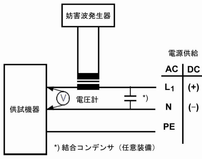
図 7.1-2. サージ・イミュニティ試験回路
