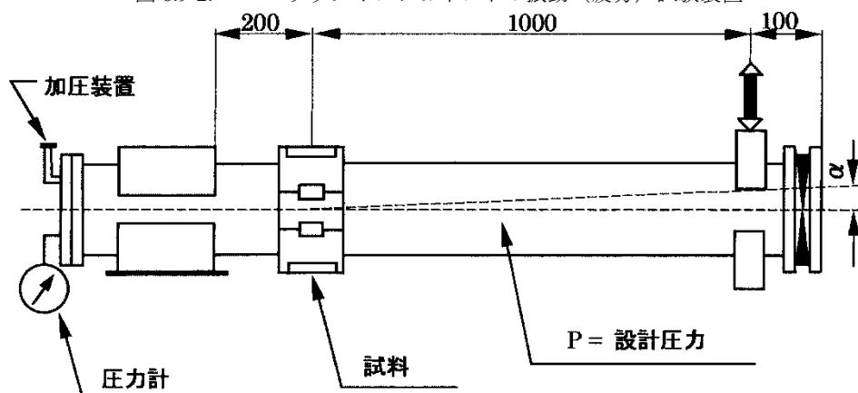
表 6.9-2. スリップオンジョイントの振動（疲労）試験要目
