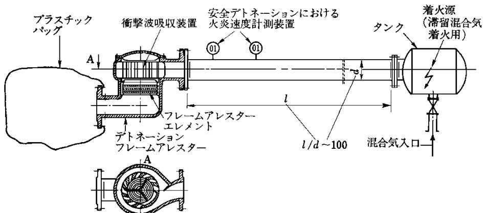
図 6.7-4. 高速排出装置の試験装置の例 (フラッシュバックテスト用)
