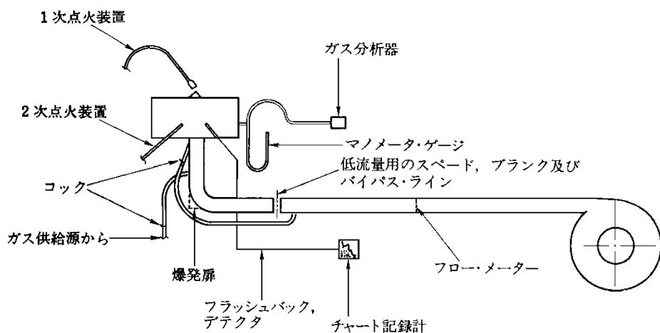
図 6.7-5. 高速排出装置の試験装置の例（連続燃焼試験用）
