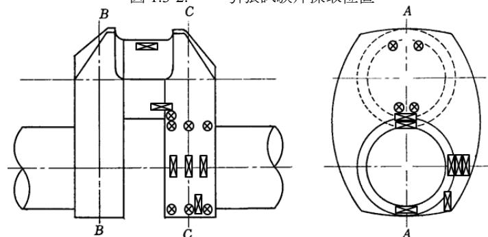
図 1.3-3. 衝撃試験（又は曲げ試験）片採取位置
