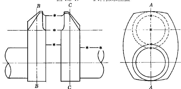
図 1.3-2. 引張試験片採取位置
