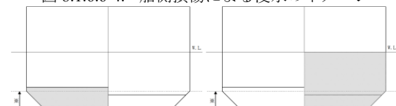
図 8.1.6.6-4. 船側損傷による浸水のイメージ
