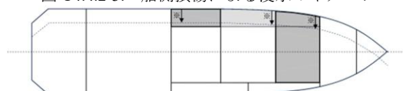
図 C4.4.2-3. 船側損傷による浸水のイメージ
