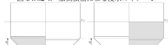
図 C4.4.2-4. 船側損傷による浸水のイメージ
