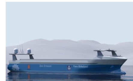
船上無人（機械による操船＋遠隔の監視）
