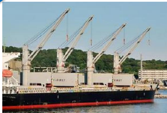
デッキクレーン
