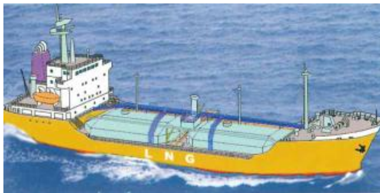
独立型タンクタイプCタンク方式の液化ガス運搬船
