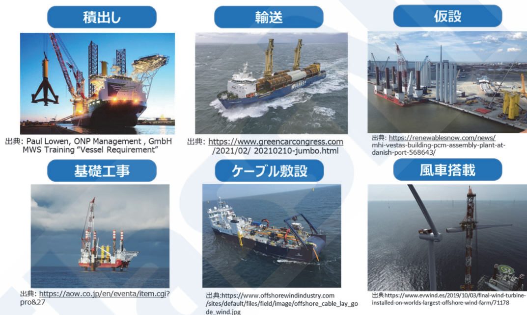
図4 洋上風力発電所の建設工程
