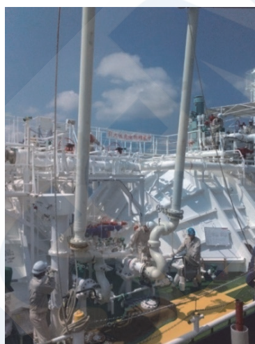
図4 LPG荷役時のローディングアーム接合部 (引火性危険物積載中と揭示)
