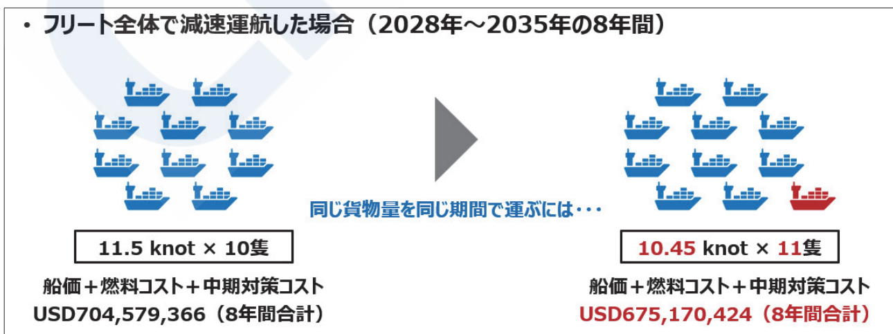
図9 フリート全体の減速運転によるコスト削減
