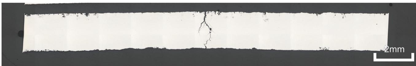
図6 HT80のSCC破面（浸漬期間：2週間）
