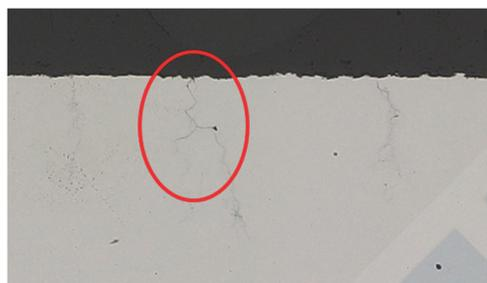
図7 HT80のSCC破面（浸漬期間：136時間）
