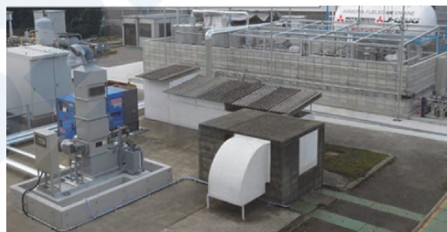
図7 ジャパンエンジン社の単気筒アンモニアテストエンジン（左）とアンモニア供給設備（右） 15)
