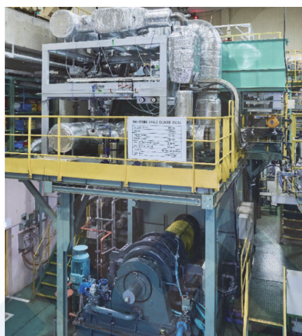
図7 ジャパンエンジン社の単気筒アンモニアテストエンジン（左）とアンモニア供給設備（右） 15)
