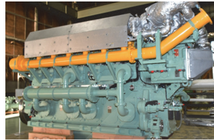
図10 A-Tug用中速4ストローク28ADF型エンジン （出力：1618kW/台・D/S：280/390mm・6気筒・ 回転数：750rpm・Pme：1.8MPa） 18)
