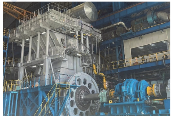
図2 WinGDの低速2ストローク・メタノール エンジン開発のための単気筒テストエンジン SCE920（シリンダ径：920mm）（WinGD社提供）
