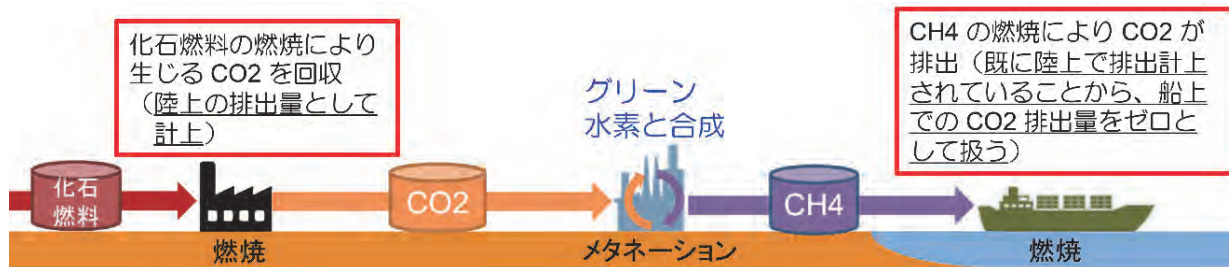
図2 カーボンニュートラルメタンの作り方の例 1)
