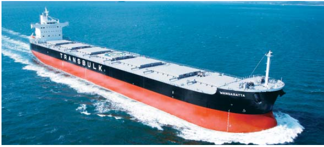
السفينة وانجارات ناقلة بضائع سائبة بحمولة ٤٣,٠١٢ طن إجمالي تم بناؤها بواسطة شركة توسونيشي لبناء السفن ليمتد لصالح شركة ميسوغا كايون ليمتد
