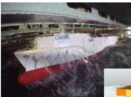
위: 대형 컨테이너선의 휘핑 반응에 관한 예인수조 테스트
