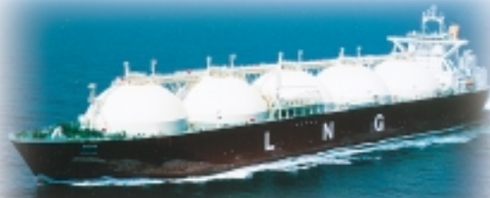
Doha—a 137,262 m 3 LNG tanker constructed by Mitsubishi Heavy Industries, Ltd. for the Qatar LNG Project
