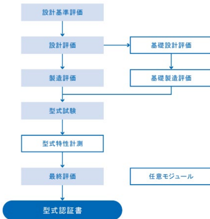
図 1 代表的な型式認証のプロセスと評価モジュール
