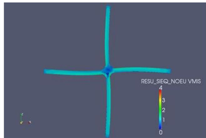
No.2の支持方法による変形がより实际的であり、目違い十字溶接継手ではNo.2の支持方法が適切な拘束方法。
