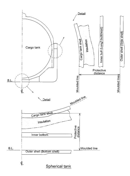
Figure 2.5(d) - Protective distance
