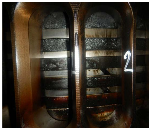
図2 ピストンリング部に発生した堆積物
