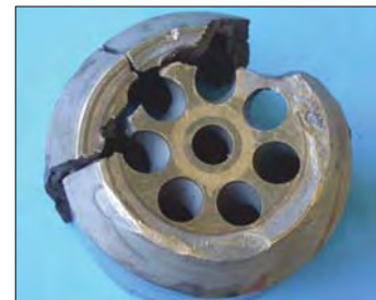
破損した油圧モータのシリンダ (アキシアル形)
