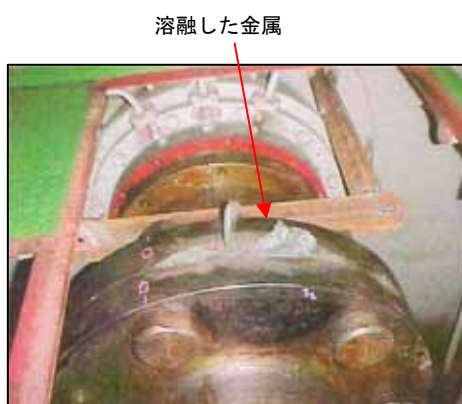
図 3.2.3 フランジの損傷状況
