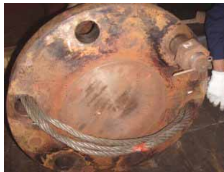
図 3.4.4 中間軸船尾側フランジ面の状況
