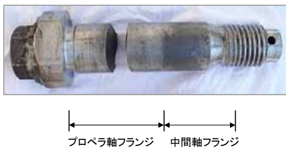
図 3.3.1 No.13 ボルトの破断位置 (洗浄後)
