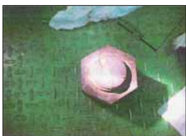
図 3.2.1 継手ボルトの破断状況
