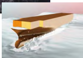
上: 大型コンテナ船のホイッピング 応答水槽試験 右: 大型コンテナ船の波浪中応答 シミュレーション
