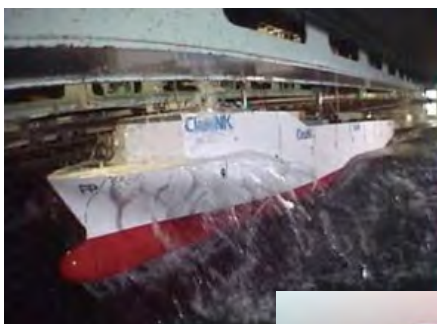
上: 大型コンテナ船のホイッピング 応答水槽試験 右: 大型コンテナ船の波浪中応答 シミュレーション
