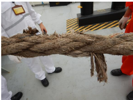
← 係船ロープの破損
