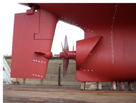
図 1.19 サーフバルブ（SURF-BULB） （ジャパン マリンユナイテッド株式会社提供）
